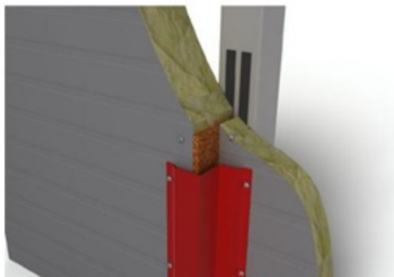
2.13 Соединение стеновой и кровельной панелей. Начало кровли. Вариант А
